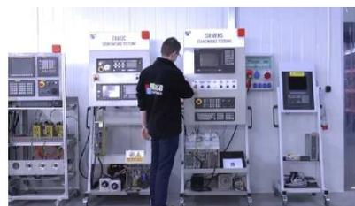
Wir verfügen über von uns entwickelte Prüfstände, mit denen wir prüfen, ob das Gerät funktionstüchtig ist. Sie sorgen dafür, dass MITSUBISHI ELECTRIC MR-J2S-500B repariert wird.
